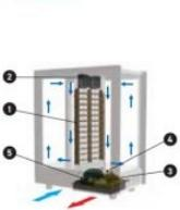
La serpentina di raffreddamento 1 e le ventole di aerazione interna 2 sono inserite al centro della vetrina all'interno dei pannelli di alluminio. Il compressore 3, il condensatore orizzontale con ventola a pala preme-
