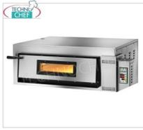
mm1080x1080x140h, con PORTA VETRO, camera di cottura interamente in refrattario, 2 TERMOSTATI REGOLABILI per SUOLA e CIELO, comandi digitali, temp.da +50° a +500 °C, Peso 225 Kg,V.230/1,kw 13,2, dim.esterne mm.1520x1210x420h
