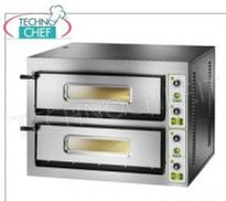
mm.720x720x140h, con PORTA VETRO, piano cottura in refrattario, 4 TERMOSTATI REGOLABILI per SUOLA e CIELO, temp.da +50° a +500 °C, Peso 146 Kg, V.230/1, kw 12, dim.esterne mm.1010x850x750h
