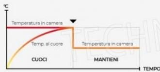
Per ogni ciclo di cottura si dovrà selezionare la temperatura della camera e poi decidere quando la cottura terminerà.
