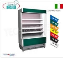
FRIGOR MURALE ESPOSITORE, Marca TECNODOM, Linea VULCANO 60, con 4 ripiani regolabili, ILLUMINAZIONE superiore a neon, temperatura +3°/+5°C, predisposto per UNITA' REFRIGERANTE REMOTA, V.230/1, Kw.0,084, Peso 170 Kg, dim.mm.1330x602x1970h
